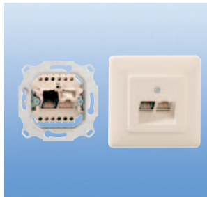
line21®-UAE 8/8 Up 225 102 01 2 x 8-polig; 2 x 4 Schraubkontakte für line21® -Systemleitung und Festanschluss Daten/Telefon; mit Spreizkrallen; für Anwendungen bis 100 Mbit/s; perlweiß (ähnlich RAL 1013); 80 x 80 x 31 mm; 52 g
