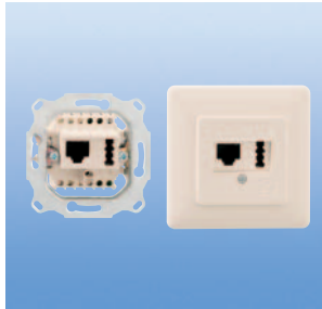
line21®-UAE/TAE Up 225 102 02 2 x 6-polig; 2 x 4 Schraubkontakte für line21® -Systemleitung und Festanschluss Daten/Telefon; mit Spreizkrallen; für Anwendungen bis 100 Mbit/s; perlweiß (ähnlich RAL 1013); 80 x 80 x 31 mm; 52 g
