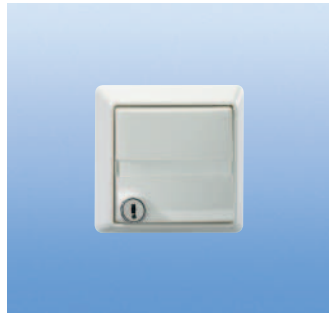
APV rw 100 100 55 Abdeckplatte; verschießbar, IP 44; Schlüssel gleichschließend, für alle Rutenbeck-Unterputzeinsätze in Verbindung mit Zentralstücken 50 x 50 mm; reinweiß (ähnlich RAL 9010); 80 x 80 mm; 10 g
