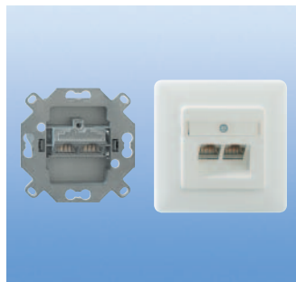
UAE-real.Cat.6-8/8 K Up 138 102 22 mit Zentralstück und Abdeckplatte; perlweiß (ähnlich RAL 1013); 80 x 80 x 47 mm; 148 g
