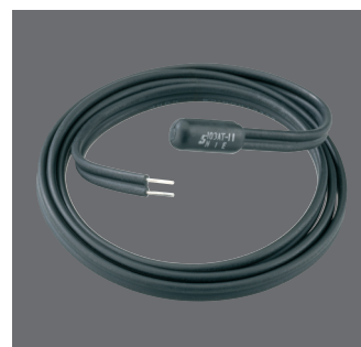
Temperatursensor 700 802 201 Auflösung 1 °C; B-Wert 3435 K ± 1 %; 10 kΩ bei 25 °C; schwarz (ähnlich RAL 9005); 600 mm; 6 g
