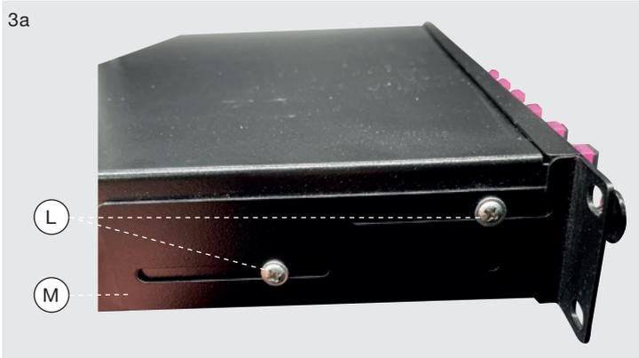
Bei Bedarf kann die Bedienfront der Spleissbox um bis zu 30 mm rückversetzt werden. Lösen Sie dazu die innenliegenden, seitlichen Befestigungsschrauben (L) vom Halter (M), verschieben Sie den Einschub (H) auf die gewünschte Position und befestigen Sie diesen dann neu.
